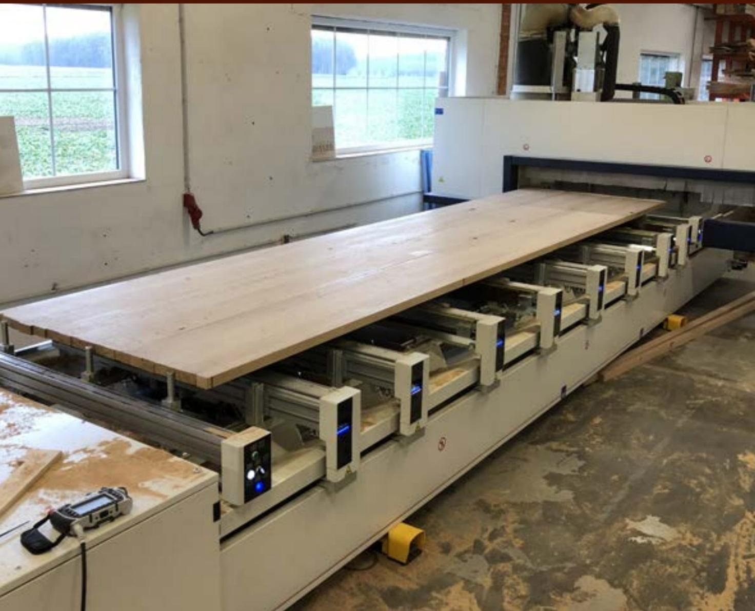
Eine fünf Meter lange Tischplatte wird auf unserer Fräse bearbeitet.
